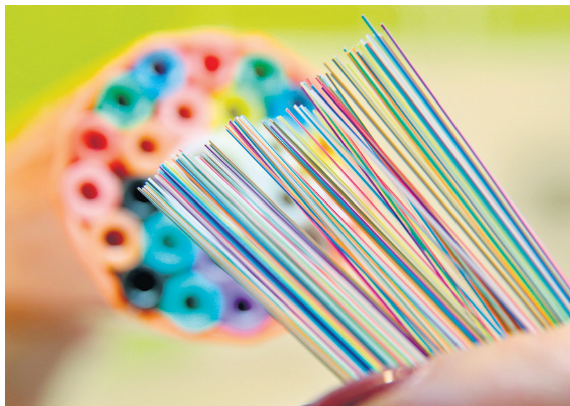
Kabelbündel aus einem Glasfaserkabel vor einer sogenannten Speedpipe. Über Herausforderungen und Chancen der Digitalisierung sprachen die Abgeordneten auch bei der Haushaltsdebatte. © dpa
