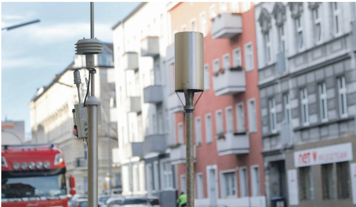
Messstation an einer stark befahrenen Straße mit angrenzenden Wohnhäusern. In vielen Städten drohen Fahrverbote, weil die Stickoxid-Werte überschritten werden.
