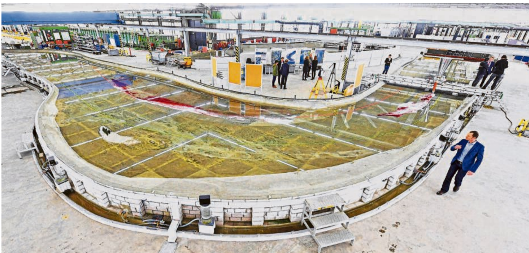
Die Vertiefung einer Fahrrinne des Mittelrheins wird in der Bundesanstalt für Wasserbau in Karlsruhe am Modell getestet.
