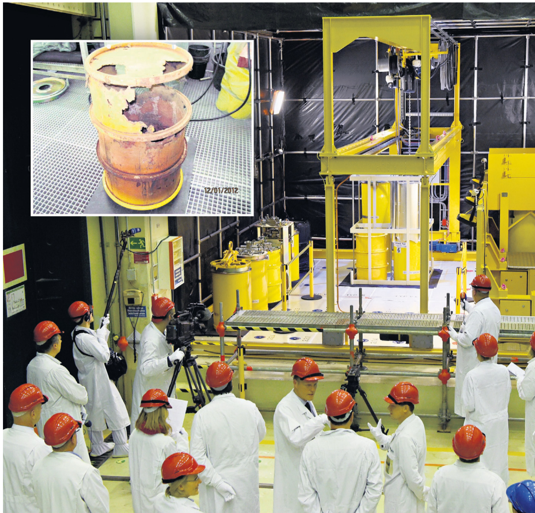
Die Bergung von teils stark verrosteten Fässern mit schwach- und mittelradioaktiven Stoffen kann jetzt beginnen.
