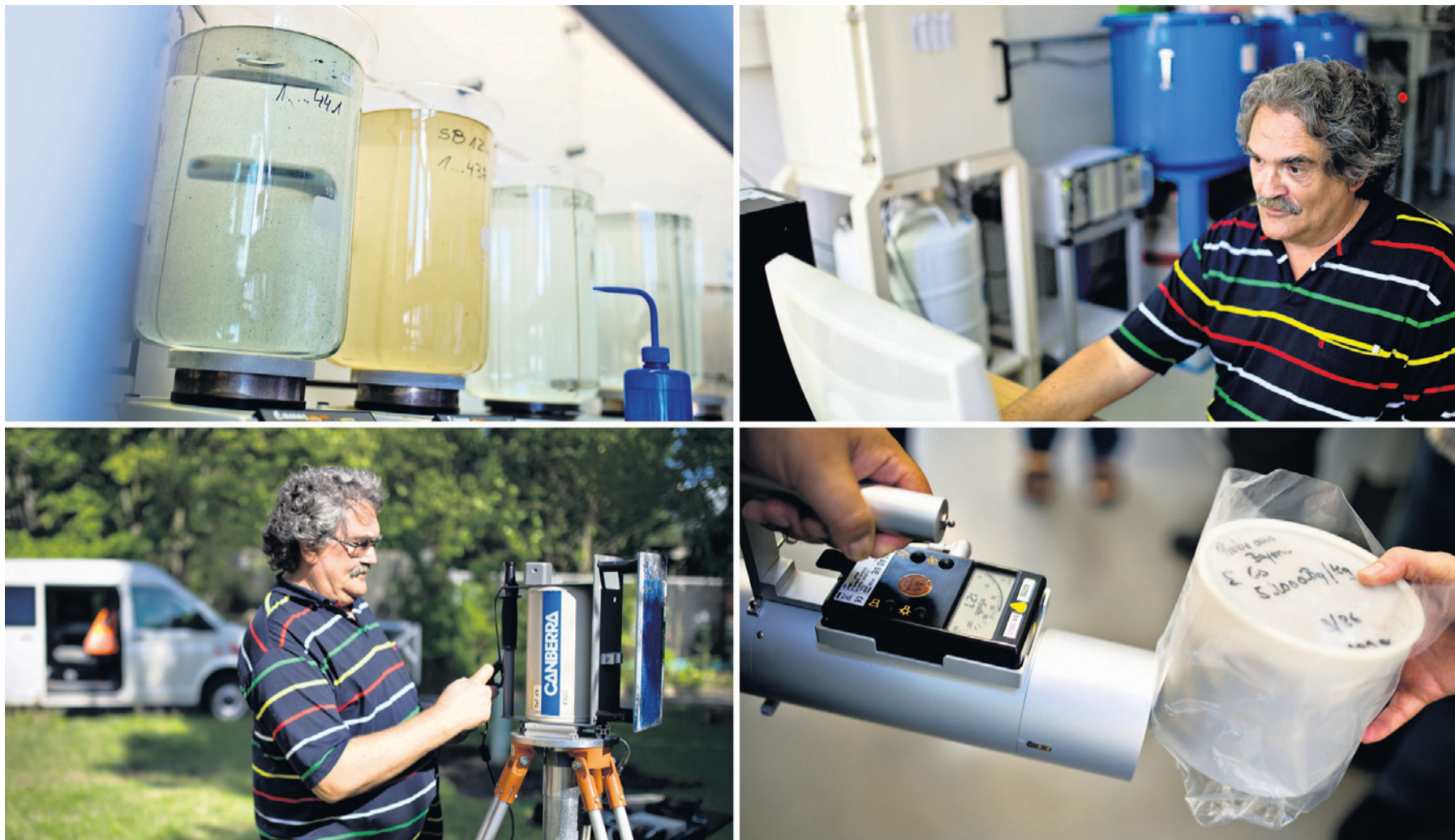
In der Strahlenmessstelle des Landes Berlin werden Proben zuerst im chemischen Labor eingedampft (oben li.) und dann im Detektor gemessen (oben re.). Der Mitarbeiter des Bereichs Umweltradioaktivität, Dominique Pottiez, zeigt eine Vor-Ort-Messung (unten re.) sowie die Auswertung einer Pilzprobe aus Tschernobyl-Zeiten (unten li.).
