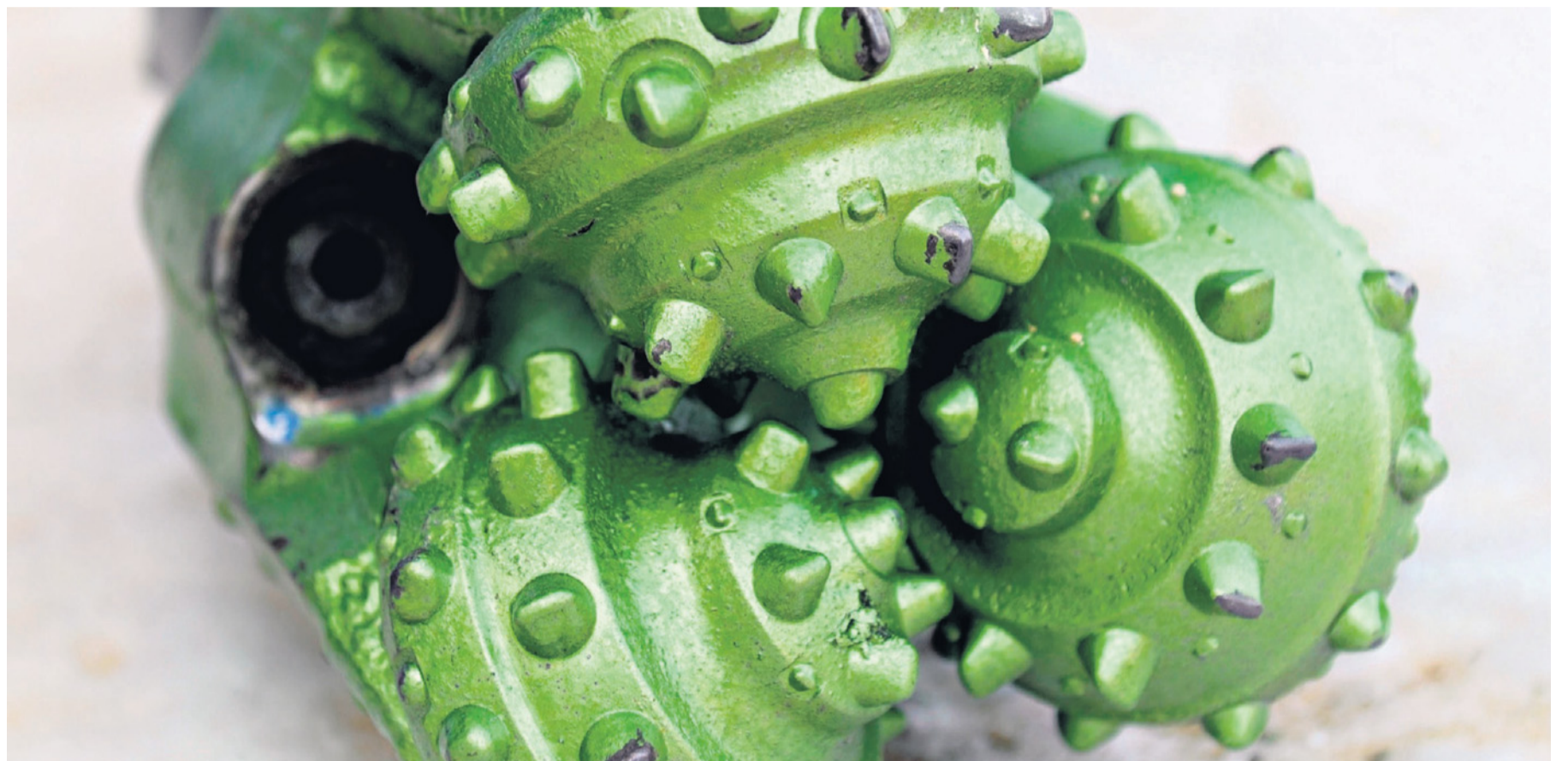
Solche Bohrköpfe arbeiten sich beim Fracking vor in bis zu fünf Kilometer Tiefe.
