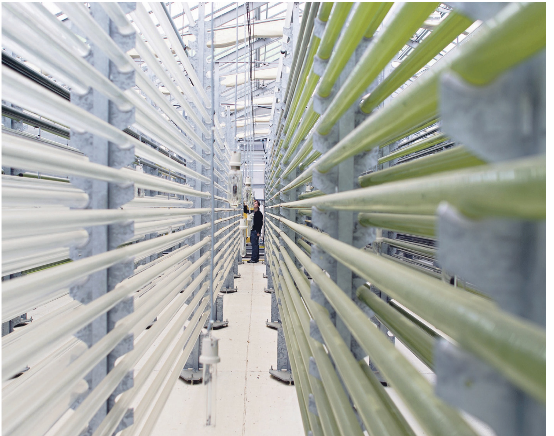
In den Bioreaktoren im sachsen-anhaltinischen Klötze werden auf 1,2 Hektar Algen für die Lebensmittel-, Futtermittel- und Kosmetikindustrie gezüchtet. Mikroalgen gelten als Schlüsseltechnologie der Zukunft. © picture-alliance/Klaus-Dietmar Gabbert/ZB
