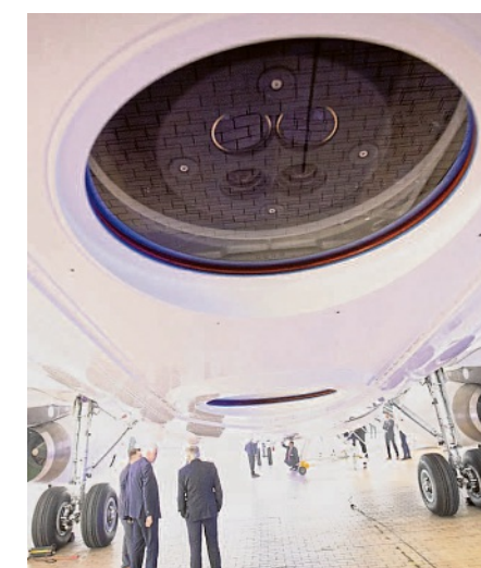
Kameras im Rumpf des A319-Open-Skies-Flugzeugs der Bundeswehr
