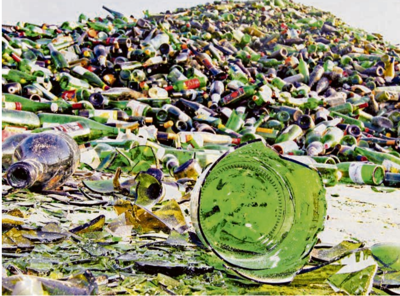
Bei Glas spielt das Recycling eine wichtige Rolle. Es wird in Sortieranlagen zerkleinert, von Fremdstoffen wie Kronkorken und Papieretiketten befreit und dann wieder eingeschmolzen.
