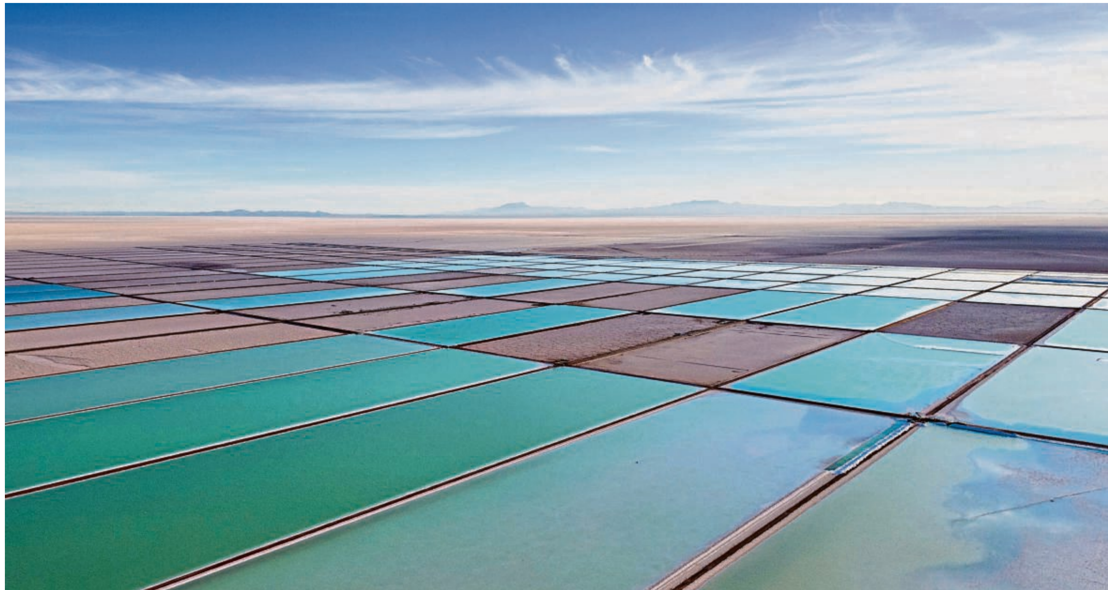
Begehrtes Leichtmetall: In der Anlage Llipi am Salzsee von Uyuni in Bolivien wird Lithium verdampft.
