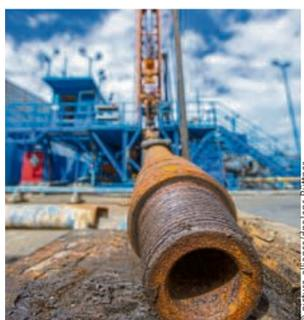
Bohrstänge auf einer Baustelle: Geothermie nutzt Energie aus der Tiefe.
