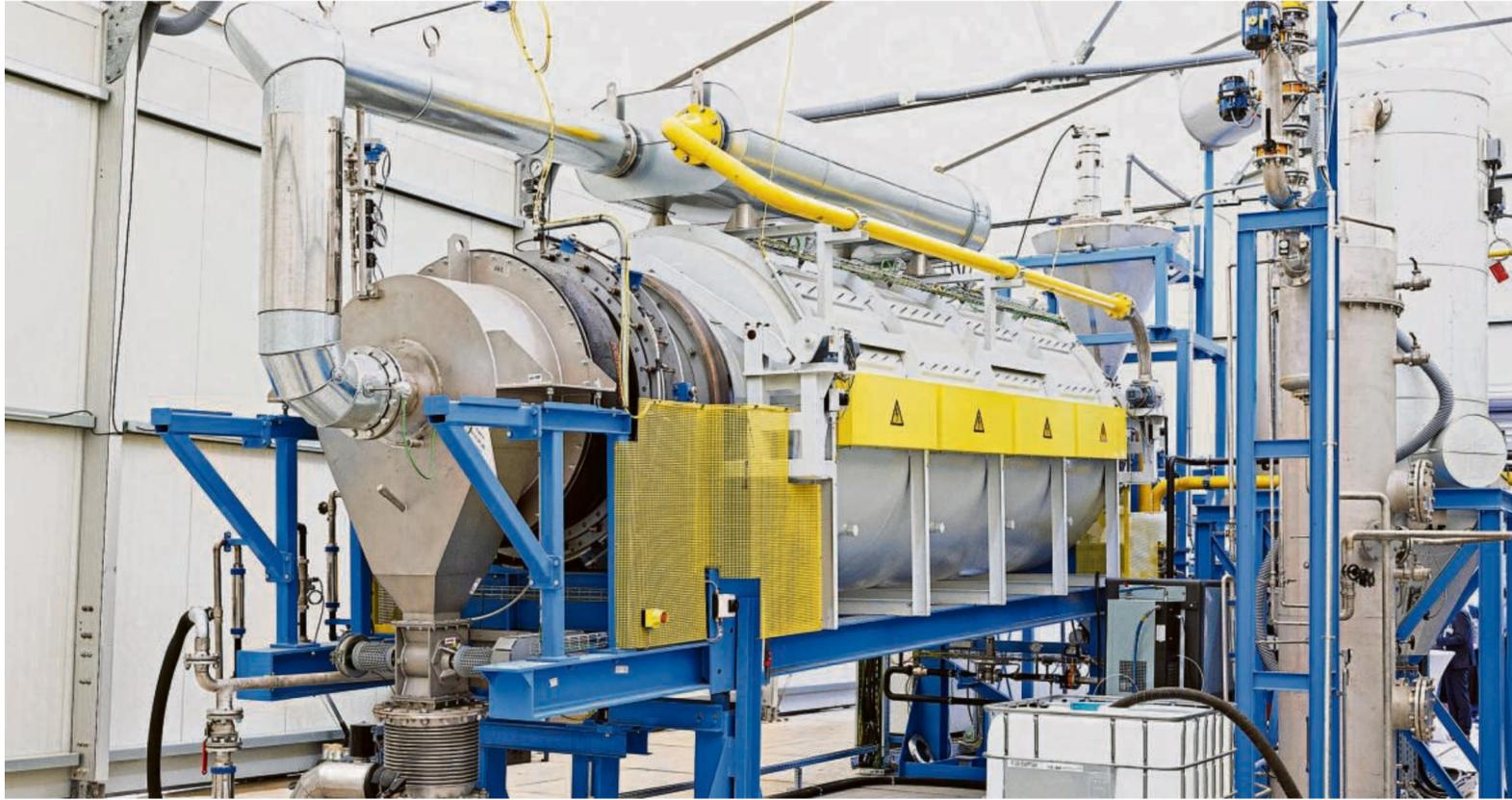
Bisher wird bei der Herstellung von Roheisen Kohle gebraucht. Mit Wasserstoff-Direktreduktionsanlagen können die CO2-Emissionen, die dabei entstehen, erheblich reduziert werden.
